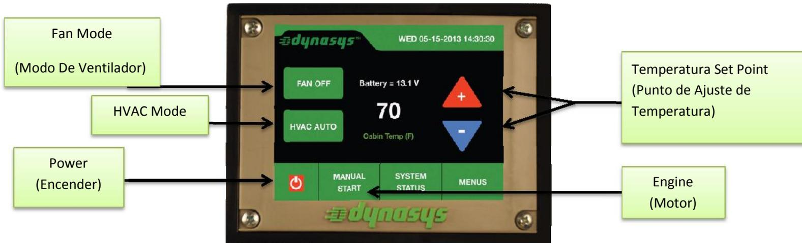
**Botón de HVAC:** Permite al usuario seleccionar los siguientes controles de temperatura: Manualmente Frio (Manual Cool), Manualmente Caliente (Manual Heat), HVAC Automatico (HVAC Auto), y HVAC apagado (HVAC Off).
